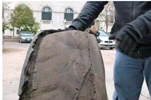
Cubierta colapsada 8.30 (200 km después)
